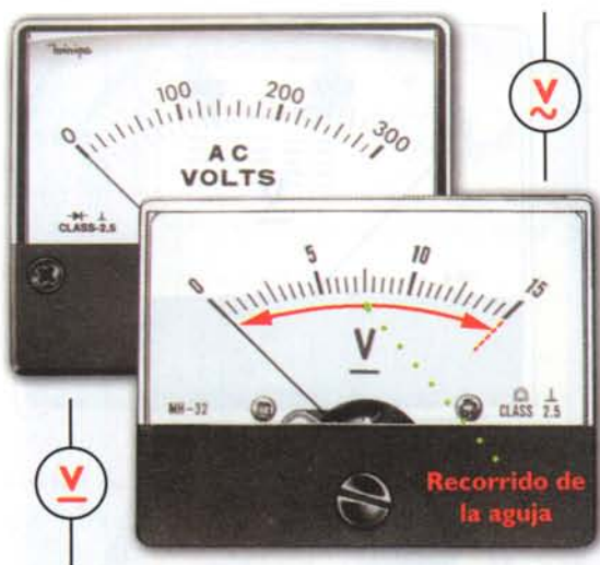
Figura 2.14. Voltímetros usados en electrónica y sus símbolos
